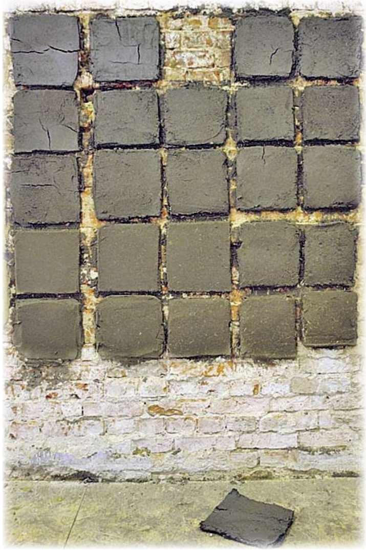
Ennen kuin aloittaa savirakentamisen, pitää sekoitukset testata ja löytää oikeat sekoitusuhteet. Tässä oikean savirappaussekoituksen selvittämiseksi tehty ruututesti.
